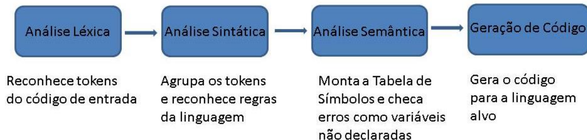
Figura 6 Diagrama de divisão do compilador em seus módulos como um pipeline. O código fonte é recebido pela análise léxica e o código Assembly é produzido pela geração de código.
