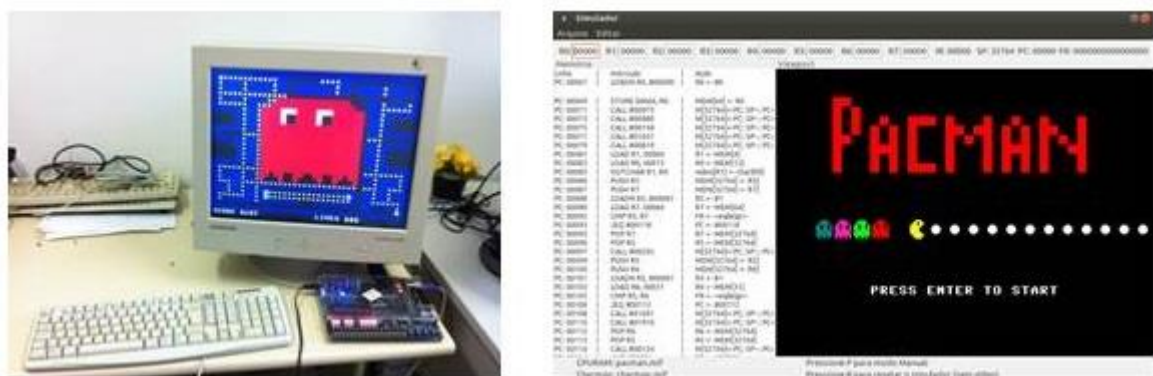
Figura 1 Kit para ensino de lógica digital, contando com processador, montador e simulador
