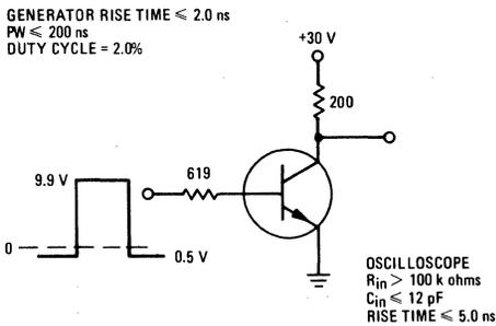
FIGURE 15 – STORAGE TIME AND FALL TIME EQUIVALENT TEST CIRCUIT
