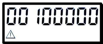
Неисправность температурного датчика № 1
