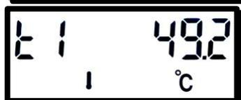
Температура подающего трубопровода
