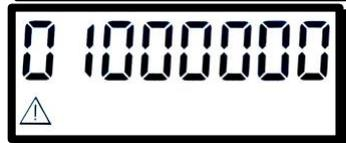
Неисправность температурного датчика № 2
