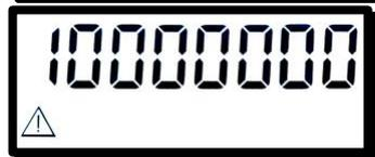
Любой из датчиков неисправен, или разность температур датчиков менее двух градусов
