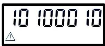
Неисправность температурного датчика № 1.
