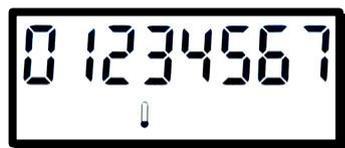
Сетевой адрес (заводской номер теплосчетчика).
