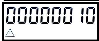
Вскрыт корпус теплосчетчика
